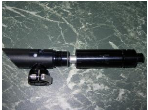
14. При помощи бумажной салфетки вытираем с болта и стопора болта всю старую смазку.
